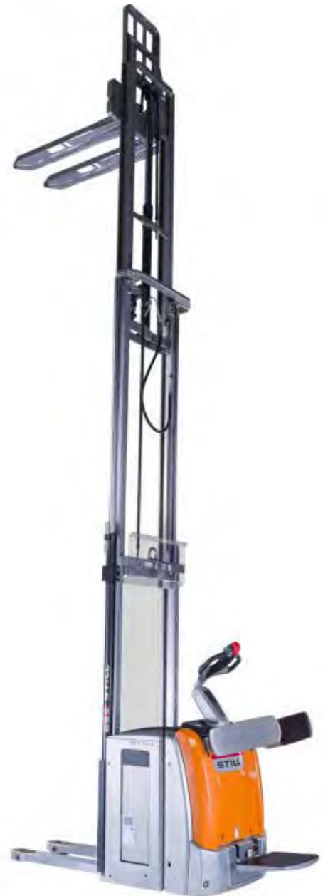
drievoudige mast met 2 uitschuifbare delen
